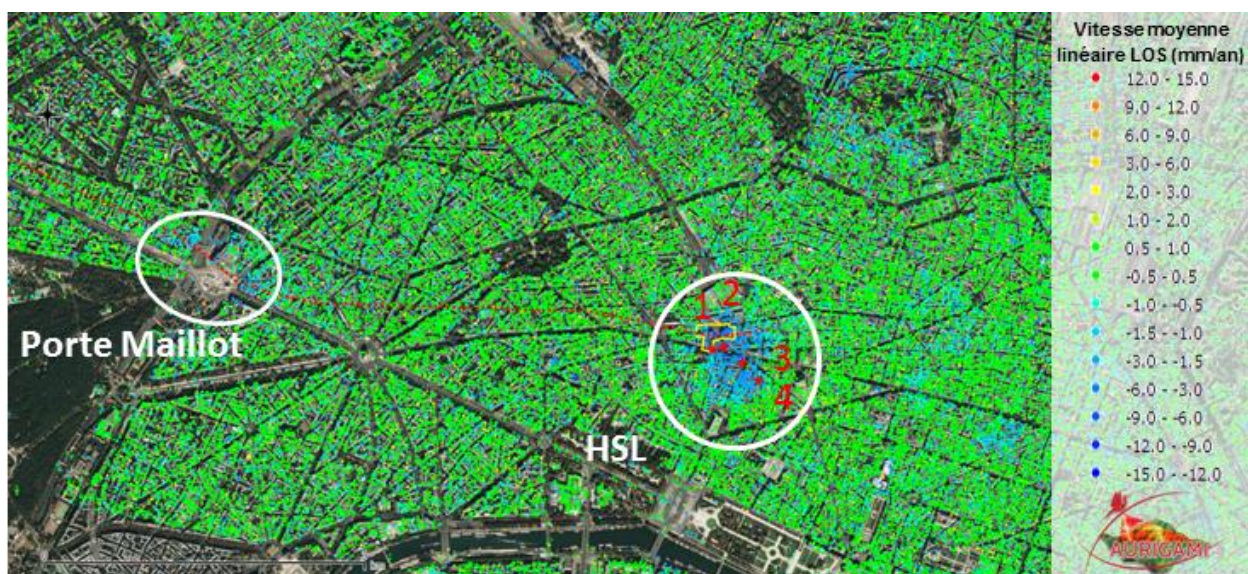
Figure 6. Carte des vitesses moyennes de déformation dans la ligne de visée du satellite sur le quart Nord-Ouest de la ville de Paris entre Mars 2016 et Juin 2019. Les numéros 1 à 4 indiquent la position des mesures présentées dans la figure 7.
